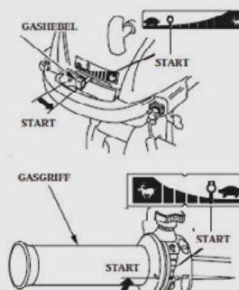
Vorsicht: Den Motor nicht anlassen, wenn sich der Gashebel bzw. der Gasdrehgriff auf der FAST-Position befindet, da sich beim Anspringen des Motors das Boot plötzlich in Bewegung setzt
