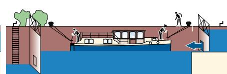
Wenn das hintere Schleusentor geschlossen ist werden die Schützen am Obertor automatisch oder vom Schleusenwärter geöffnet. Jetzt strömt Wasser in die Schleusenkammer. Jeweils eine Person an Bord nimmt die vordere und die hintere Leine beim Ansteigen des Bootes laufend dichter. Halten Sie das Boot eng an der Schleusenwand. Wenn Sie sich dicht am Obertor der
