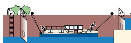
Stellen Sie den Motor ab. Nach Betätigung des Weiterschleusungsschalters ([Anleitung links oben](#)), automatisch oder vom Schleusenwärter werden die Schleusentore hinter dem Boot geschlossen.
