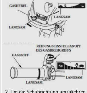
2. Um die Schubrichtung umzukehren, den Außenborder um 180° drehen, dann die Ruderpinne ebenfalls drehen, wie in der Abbildung gezeigt. Bei Ausführungen mit Gasdrehgriff darauf achten, dass der Gasdrehgriff beim Herumschwingen der Ruderpinne nicht festgehalten wird.
